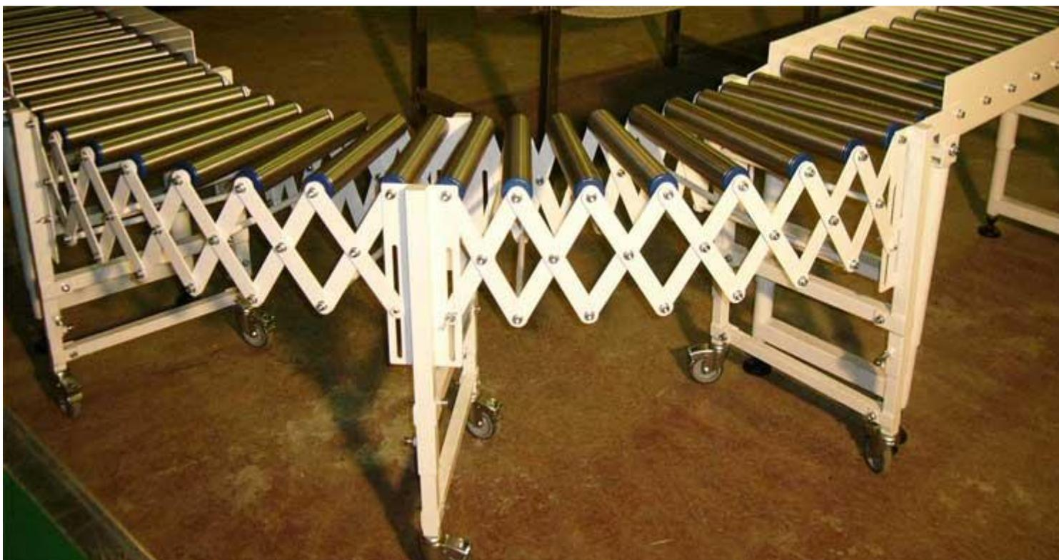
Гравитационный раздвижной рольганг с изменяемым углом поворота. Ролики производства «П.Т.групп». Варианты исполнения роликов: нержавеющая сталь Ø 48 мм, пластик Ø 50 мм. Регулировка высоты в диапазоне 600÷950 мм. Регулировка длины 610÷1650мм. Регулировка угла поворота 0÷45 градусов. Колесные опоры с фиксацией.
