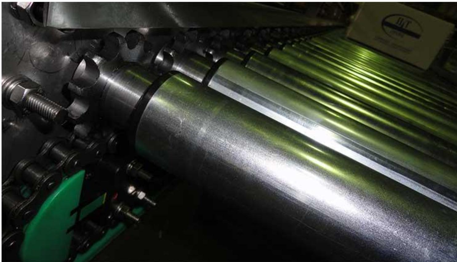
Специальная конструкция ролика обеспечивает аккумуляцию перемещаемого груза с остановкой ролика под грузом.
