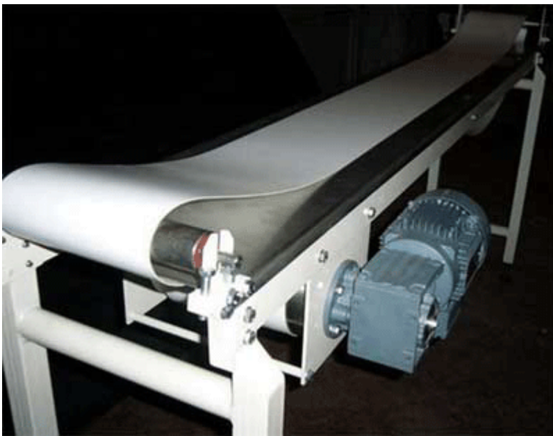
Рис. 19: При повороте барабана снимается натяжение ленты и обеспечивается необходимое пространство для очистки стола.
