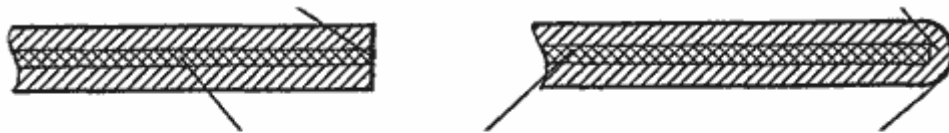
Рис. 17: Упрочнение ленты. (a) Открытые края ленты являются областью для проникновения жидкости в прослойки тягового каркаса; (b) покрытие краев ленты наружными обкладками. Для более удобной очистки лента может быть съемной (см. рис. 18).
