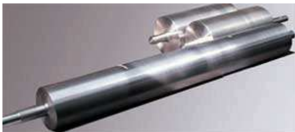
Рис. 21 Конструкция барабанов. (а) углубления на боковых поверхностях барабанов образуют «мертвые зоны» скопления продукта; (б) сплошные сварные боковые поверхности, предотвращают возможность возникновения гигиенического риска и легко очищаются.
