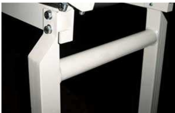
Рис. 23: Поперечные сечения полой станины. (а) Выступы поперечных сечений являются местом скопления пыли при установке в горизонтальном положении; (б) закрытые или открытые поперечные сечения должны использоваться таким способом, чтобы пыль не могла скапливаться.
