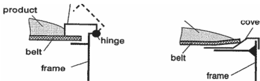
Рис. 18: Бортовые области ленточных конвейеров. (a) Несъемные бортовые кожухи также как и откидные сложно очищаемы; (b) съемные бортовые кожухи предпочтительнее для более легкой очистки ленты.
