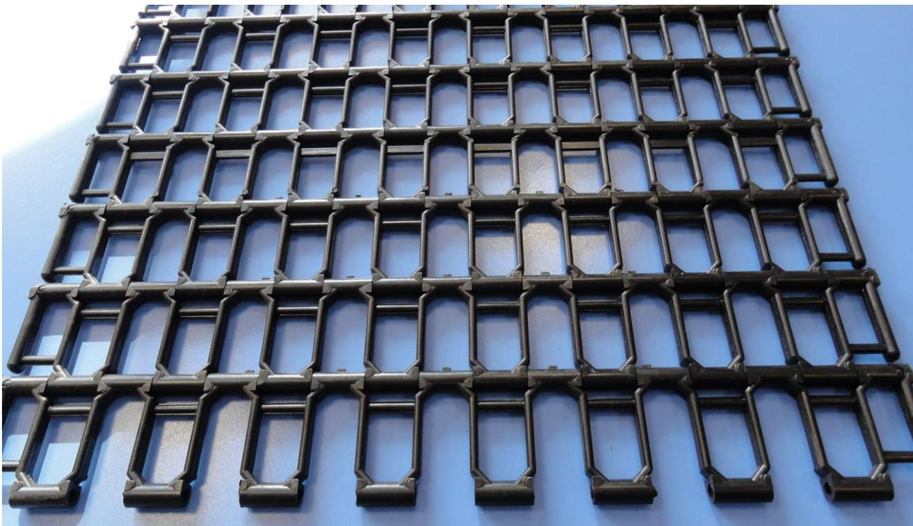
Транспортёрные ленты (ячеистые сетки) из прочной износостойкой пластмассы. Полная аналогия с зарубежными лентами по геометрическим параметрам, прочностным и износостойким характеристикам. Материал изготовления – стеклонаполненный полиамид ПА6-210 КС. Ширина модульной ленты стандартно 325 и 425 мм. Ширина может быть уменьшена кратно 25 мм (путем обрезания боковых ячеек).
