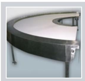
Использование поворотного ленточного транспортера позволяет решать проблемы размещения оборудования в цехе. Основное преимущество поворотного конвейера - обеспечение равномерности потока транспортируемой продукции при существенной экономии места на производстве.
