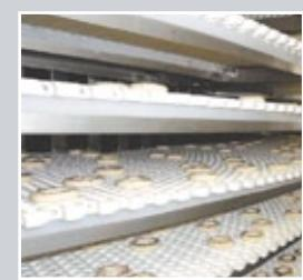
Установка климат контроля имеет полностью автоматическое управление. Необходимо всего лишь подвести к ней пар и выставить на пульте управления желаемую температуру и влажность. Точность поддержания указанных выше параметров в пределах 1%. Установка климат-контроля имеет систему принудительной конвекции воздуха, что позволяет иметь равномерную воздушную среду по всему объёму камеры.
