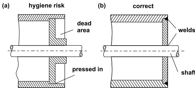
Конструкция барабанов. (а) углубления на боковых поверхностях барабанов образуют «мертвые зоны» скопления продукта; (б) сплошные сварные боковые поверхности, предотвращают возможность возникновения гигиенического риска и легко очищаются.
