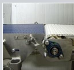
Конвейеры с металлодетекторами предназначены для обнаружения в продукции включений металла. При обнаружении металла раздается свето-звуковой сигнал или конвейер автоматически отбраковывает продукцию. Мы устанавливаем металлодетекторы «Sartorius» и «Metler Toledo».
