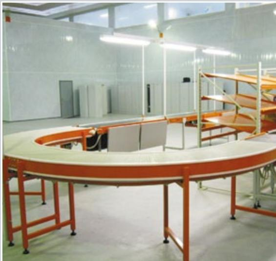
Высокая температурная область использования от -70 до +130°C. Ленты типа Flush Grid дают возможность для оптимального проникновения воздуха и жидкости сквозь ленту для лучшего охлаждения и мытья продукта при транспортировке.
