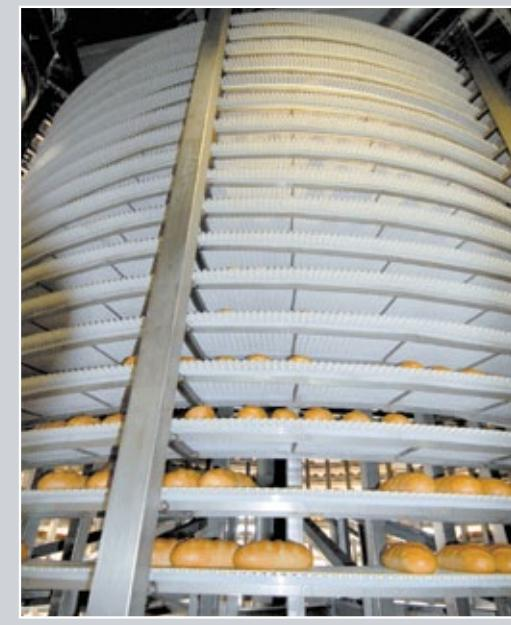
Ведущую роль в надёжности спирального конвейера имеет конвейерная лента. Мы используем лучшую ленту, специально разработанную для охлаждения хлебобулочной продукции - HABASIT M5290 (93).
