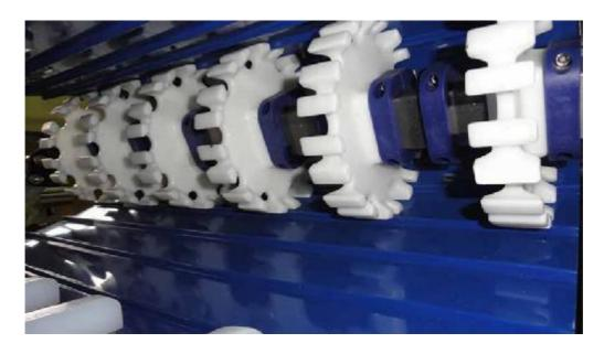
Таким образом, конвейер лишается недостатков присущих обычным ленточным конвейерам – лента не убегает, не проскальзывает, минимум регулировок натяжения.
