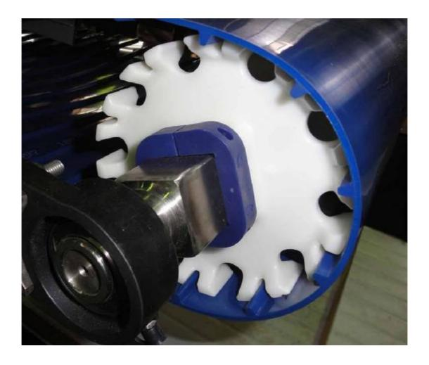
Специальный дизайн конвейеров, предотвращает возможное скопление продукта на раме, отсутствие «мертвых зон», легкая разборка конвейеров для полной мойки. В серии CleanLine используются ленты Habasit Cleandrive®.
