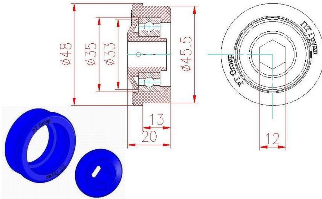
Для монтажа роликов используются подшипники серии 80103, нержавеющая труба  $\phi 48 \times 1,5$ ;  $48,3 \times 1,5$  мм или труба ПВХ  $\phi 50 \times 2,4$  мм.
