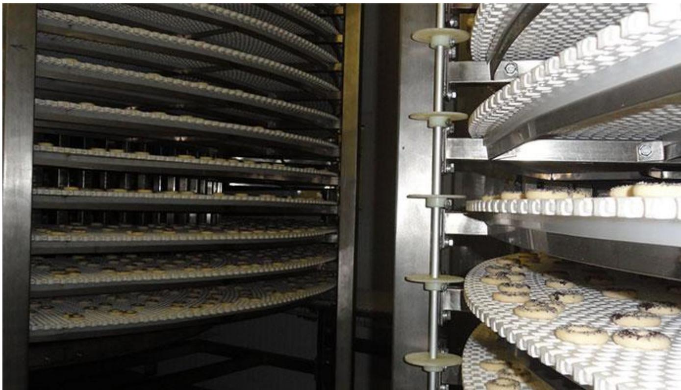
Установка климат контроля имеет полностью автоматическое управление. Необходимо всего лишь подвести к ней пар и выставить на пульте управления желаемую температуру и влажность. Точность поддержания указанных выше параметров в пределах 1%. Установка климат-контроля имеет систему принудительной конвекции воздуха, что позволяет иметь равномерную воздушную среду по всему объёму камеры.
