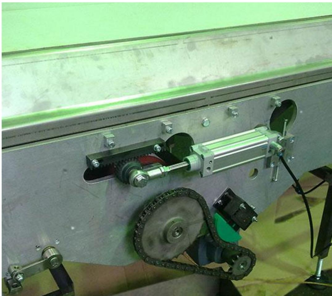
2. Системы автоматической натяжки и выравнивания ленты на ходу.
