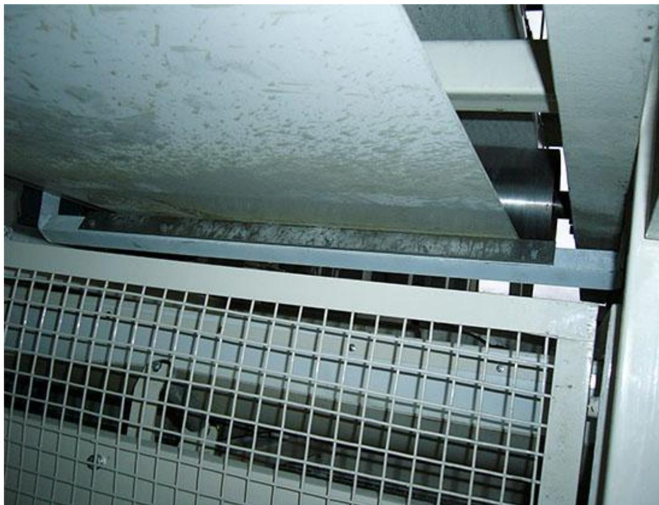
3. Скребки для очистки ленты на ходу. Изготавливаются из металла, пластика.
