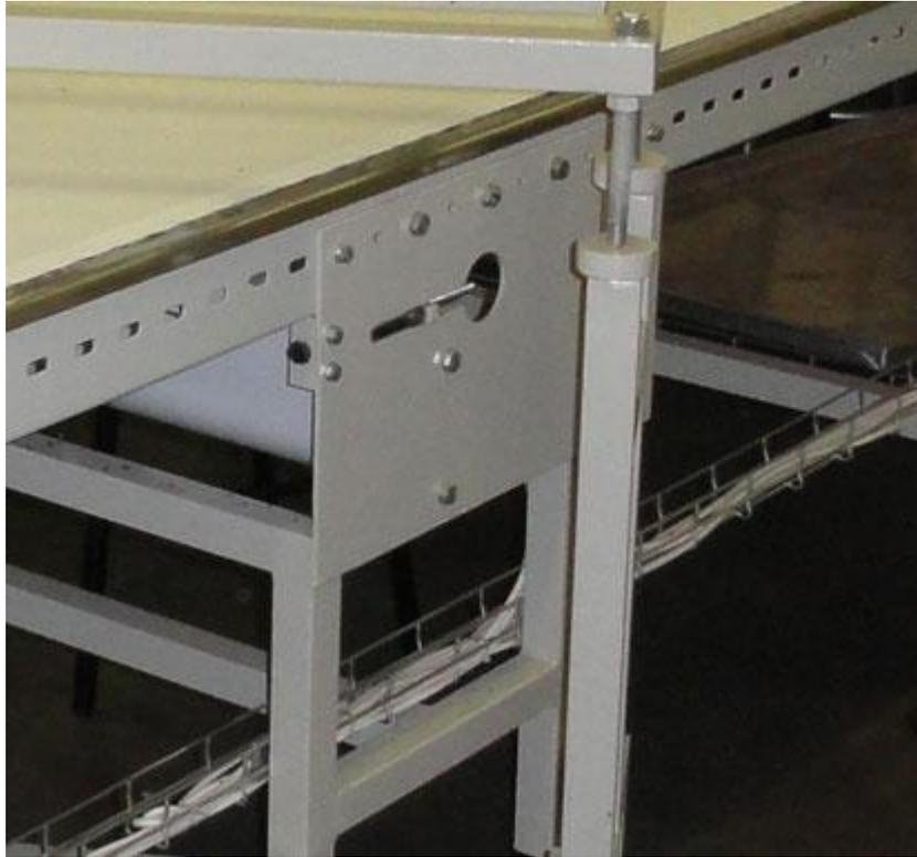
При использовании концевого привода натяжка и регулировка ленты концевым роликом.
